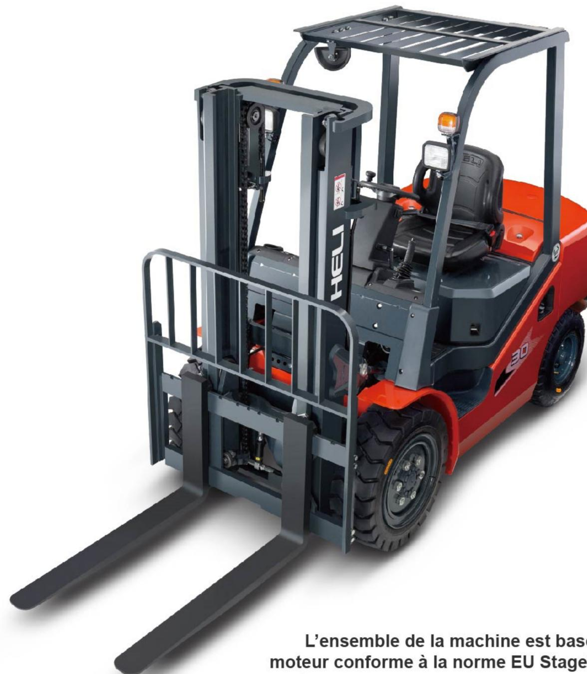
L'ensemble de la machine est basé sur un moteur conforme à la norme EU StageV et à la norme américaine de protection de l'environnement ;
